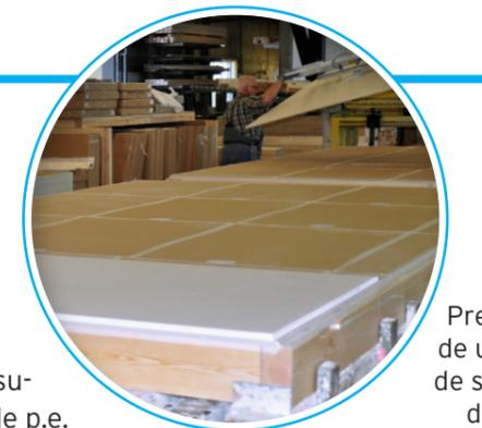
Prefabricado de un tabique de separación de vivienda
